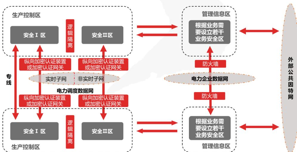
生产控制区与电力监控专用网络的广域网进行通信时，可能面临来自广域网的网络攻击、病毒入侵等安全风险，可能造成电力生产控制系统瘫痪、生产数据泄露等后果。为了保障生产控制区与广域网之间传输数据的完整性和安全性，防止非授权设备接入电力监控系统，需要在生产控
