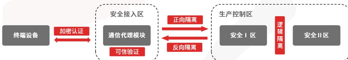
安全接入区作为生产控制区与外部网络之间连接的桥梁，在电力监控系统中承担数据通信与转发、安全隔离等重要功能。本条目明确了安全接入区需要遵循一系列安全防护规定，以确保电力监控系统的安全稳定运行。
